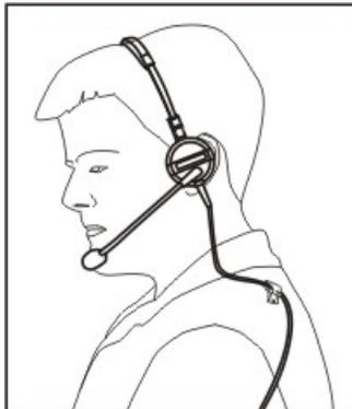
耳机由听筒、麦克风、衣夹、电缆组成。耳机与音频电缆的音频电缆端相连，而音频电缆又与 Thor VM2 相连。将音频连接器与耳机快接电缆端对准。将电缆端紧紧地挤压在一起，直至它们发出喀哒声并锁定到位。
