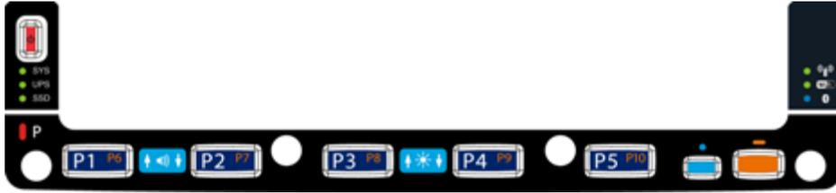
集成键盘包含五个可编程按键、一个蓝色修改键和一个橙色修改键。按橙色键和 P1-P5 使用 P6-P10。默认的可编程按键功能如下文所述。自定义设置可替换默认功能。请咨询您的系统管理员。
