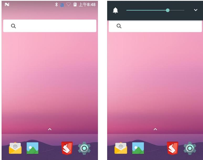
2. 按音量键或滑动音量条来调整音量，按住音量键-，或者音量条拉到最左边，将会启动振动模式。
