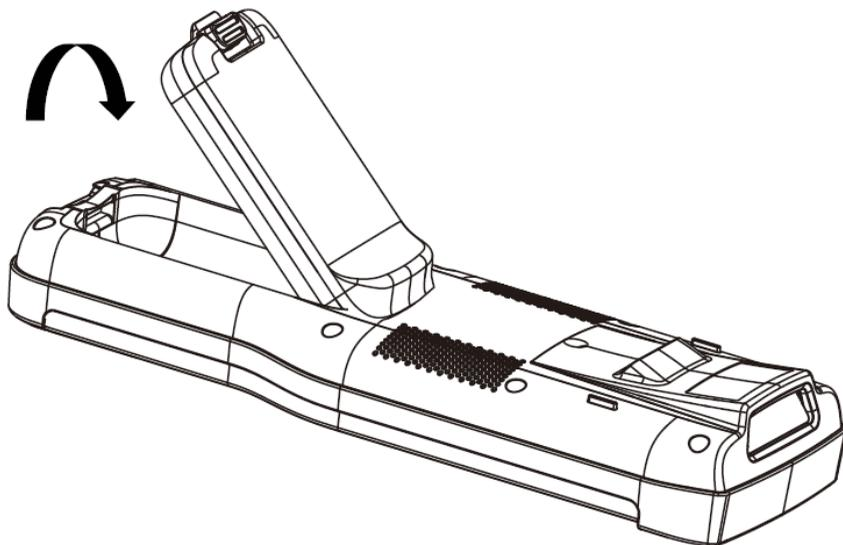
4. 朝箭头方向按压电池背面，直至电池锁扣处的机构锁定，电池安装完毕。
