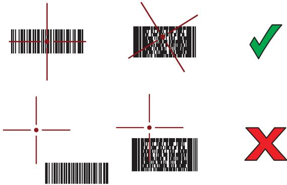
图 92 条码拣读模式，并且瞄准框中有多个条码
