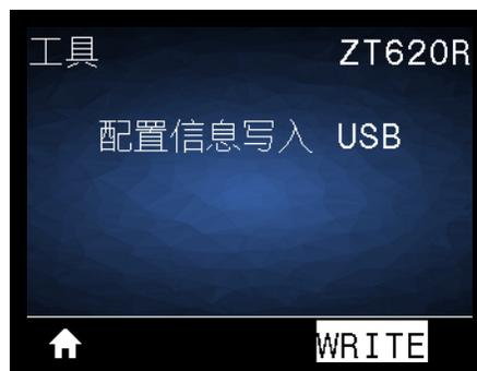
使用该功能将打印机的配置信息复制到 USB 大容量存储设备，例如 USB 闪存盘，该设备插入到打印机的其中一个 USB 主机端口中。这样无需打印物理标签，就可以获取配置信息。要将配置信息打印到标签上，请参见第 119 页的“打印信息”。
