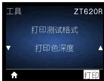
使用此菜单选项启动测试序列，打印特定类型的标签来帮助您排查打印问题。参见第 230 页的“[打印测试格式选项](#)”，查看标签样例和其他信息。
