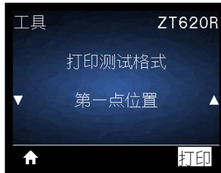
根据需要，打印机会打印一张图像来帮助您调节标签上的图像位置。图像上的线条从标签顶部打印到左边，以确定标签左上角应该是什么。
