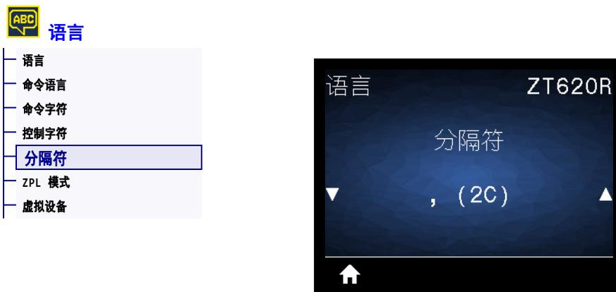
分隔符是一个两位十六进制值，在 ZPL/ZPL II 格式指令中用作参数位置标记符。设置分隔符，使其与标签格式中使用的值匹配。
