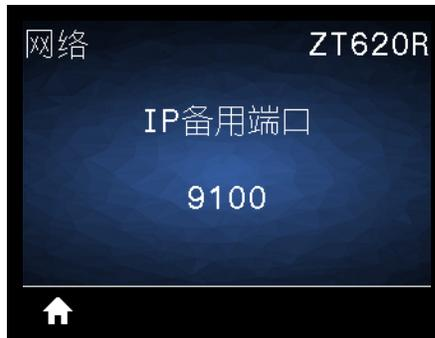
该命令用于设置 TCP 备用端口的端口号。
