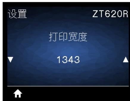
指定所用标签的宽度，以点为单位。根据打印头 DPI 值的不同，默认值为适用于打印机的最大宽度。
