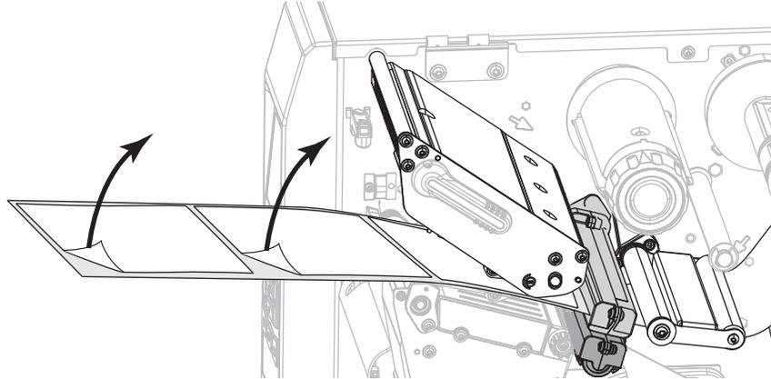
5. 将介质拉入打印机，以便只让背衬位于介质传感器底部的绿灯上方。
