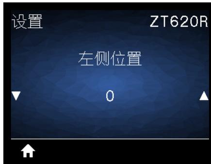
根据需要，调节图像在标签上的横向打印位置。
