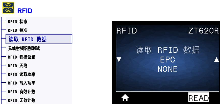
从位于 RFID 天线上方的 RFID 标签中读取并返回指定的标签数据。读取标签数据的过程中打印机不会运转。打印头会打开或关闭。
