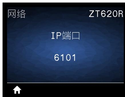
打印机的这项设置是指 TCP 打印服务正在监听的内部有线打印服务器的端口号。来自主机的正常 TCP 通信应当传输到该端口。
