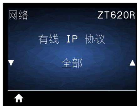
该参数用于表示用户（永久）或服务器（动态）是否选择有线打印服务器的 IP 地址。如果选择了动态选项，该参数可确定这个打印服务器如何从服务器接收 IP 地址。有关详细信息，请参见第 257 页的“更改 IP 地址”。
