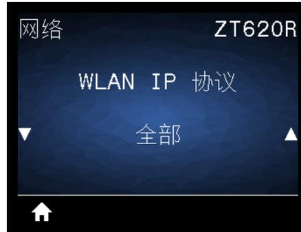
该参数用于表示用户（永久）或服务器（动态）是否选择无线打印服务器的 IP 地址。如果选择了动态选项，该参数可确定这个打印服务器如何从服务器接收 IP 地址。有关详细信息，请参见第 257 页的“更改 IP 地址”。
