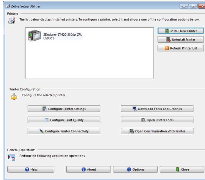
10. 单击 Install New Printer（安装新打印机）。
