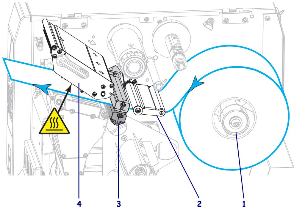
7. 从打印机中将介质拉出大约 500 毫米（18 英寸）。从这段露出的介质上取下标签并丢弃，只留下背衬。
