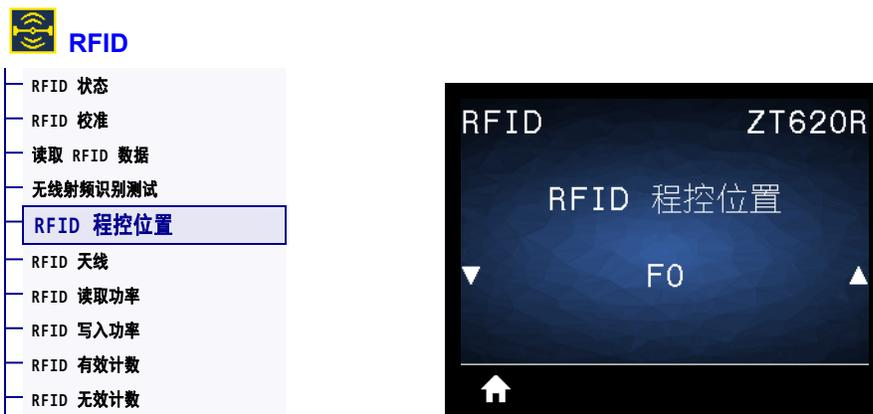
如果通过 RFID 标签校准没有达到所要求的程控位置（读取 / 写入位置），则可能要指定一个值。
