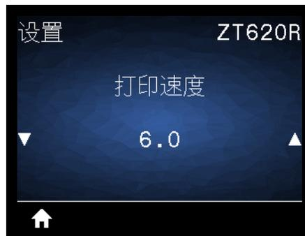
选择标签的打印速度，单位为英寸 / 秒 (ips)。降低打印速度通常能够获得更高的打印质量。
