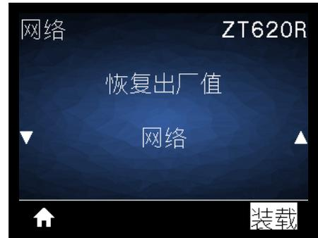
可将特定打印机、打印服务器和网络设置恢复为出厂默认值。在恢复出厂值时应小心，因为执行此操作后，将需要重新加载您已经手动更改的所有设置。这个菜单项可通过两个带有不同默认值的用户菜单访问。
