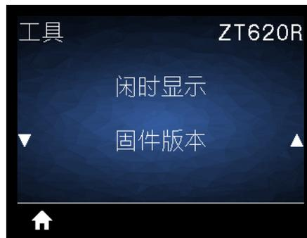
当打印机处于空闲状态时，选择打印机显示屏上显示的信息。
