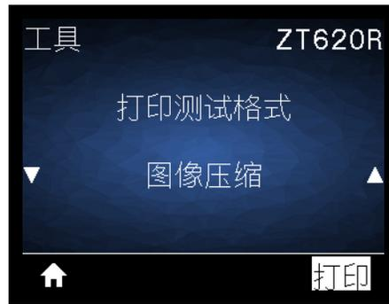
打印机打印一张带有对角线、圆圈和图像边缘均匀分布有刻度标记的图像，这有助于发现与图像压缩或拉伸相关的问题。您还可以测量刻度标记之间的距离，或对比圆圈或线条，以确定是否有变形的地方。
