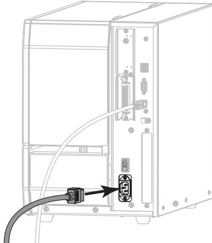
5. 将交流电源线的插头一端插入适合的电源插座。
