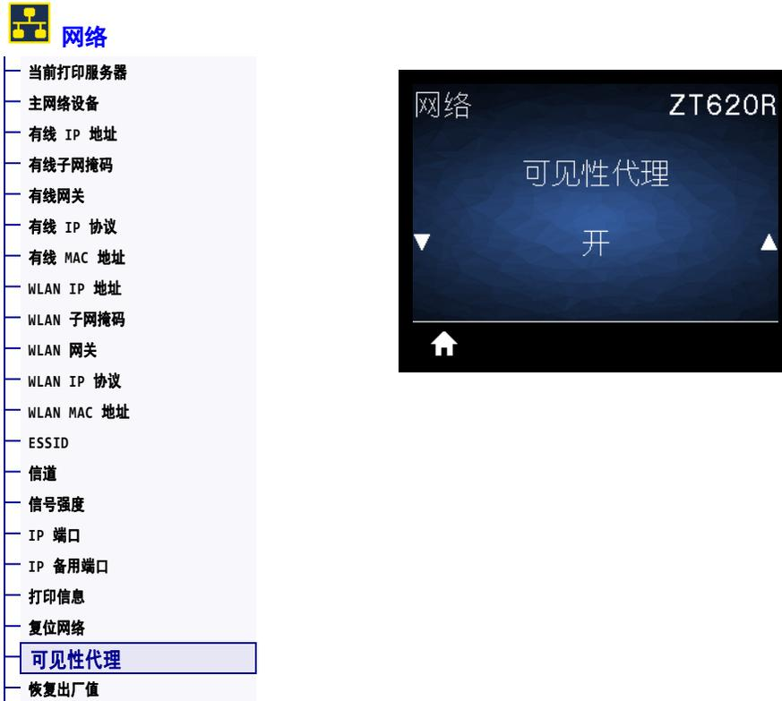
当打印机连接到有线或无线网络后，其将使用已加密、有证书认证的网络套接字连接尝试通过基于云的 Zebra Printer Connector 连接至 Zebra 的 Asset Visibility Service。打印机将发送发现数据、设置和警报数据。通过任何标签格式打印的数据将不会被传输。
