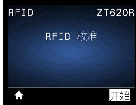
为 RFID 介质启动标签校准。（与介质和色带校准有所不同。）在此过程中，打印机移动介质，校准 RFID 标签位置，然后为正在使用的 RFID 介质确定最佳设置。这些设置包含编程位置、要使用的天线元件和要使用的读取 / 写入功率级别。请参阅 *RFID Programming Guide 3 (RFID 编程指南 3)*，了解更多详细信息。
