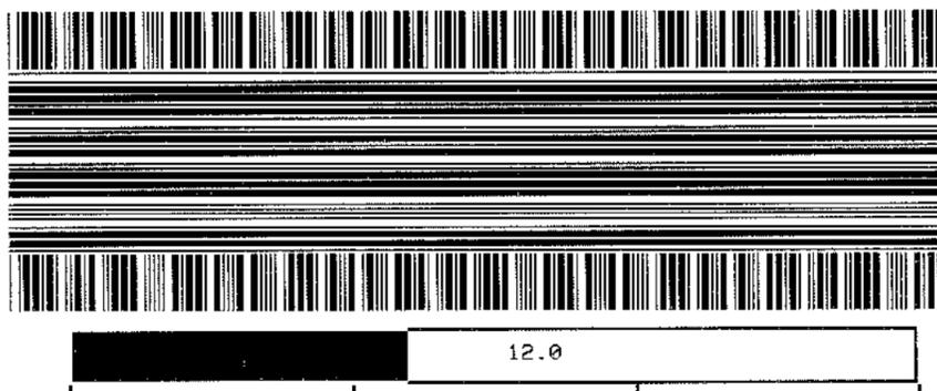
使用图像上的数字来确定最佳打印色深度。根据需要，更改打印色深度设置，直至能够在上述标签中获得最佳结果。（参见第 104 页的“[打印色深度](#)”。）
