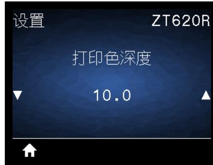
将打印色深度设定为可提供最佳打印质量的最低数值。如果打印色深度值设置过高，则可能无法打印出清晰的标签图像，无法正确扫描条形码，色带可能也会烧穿，或者打印头可能会过早磨损。
