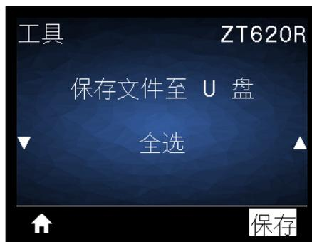
“全选”选项可将打印机上的所有可用文件存储到 USB 闪存盘中。所有已复制的 .ZPL 文件都会进行后处理，使其内容适合发送到打印机，以便能够正常执行。
