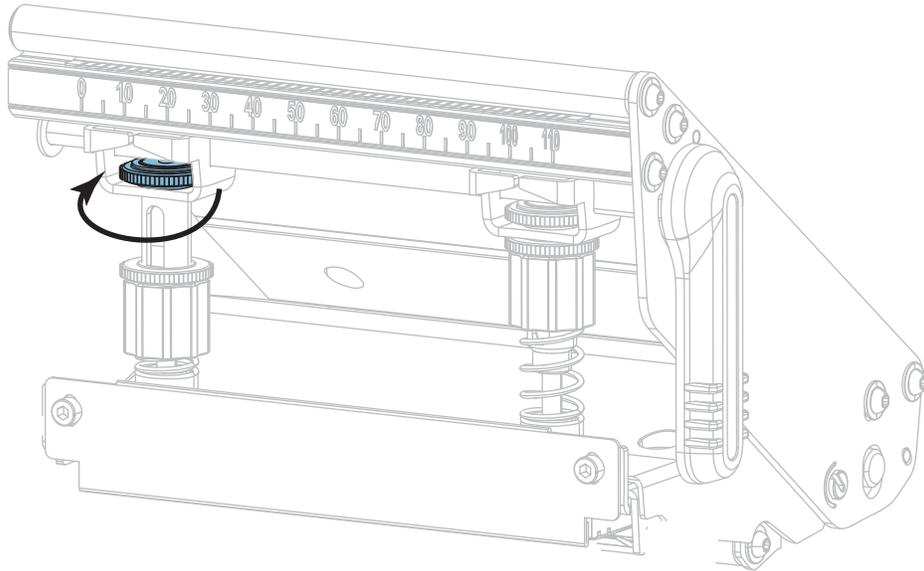
3. 根据需要，调节压紧件的位置，以便在介质上施加均匀的压力。对于非常窄的介质，应将内侧压紧件放置在介质的中央，并减小外侧压紧件上的压力。
