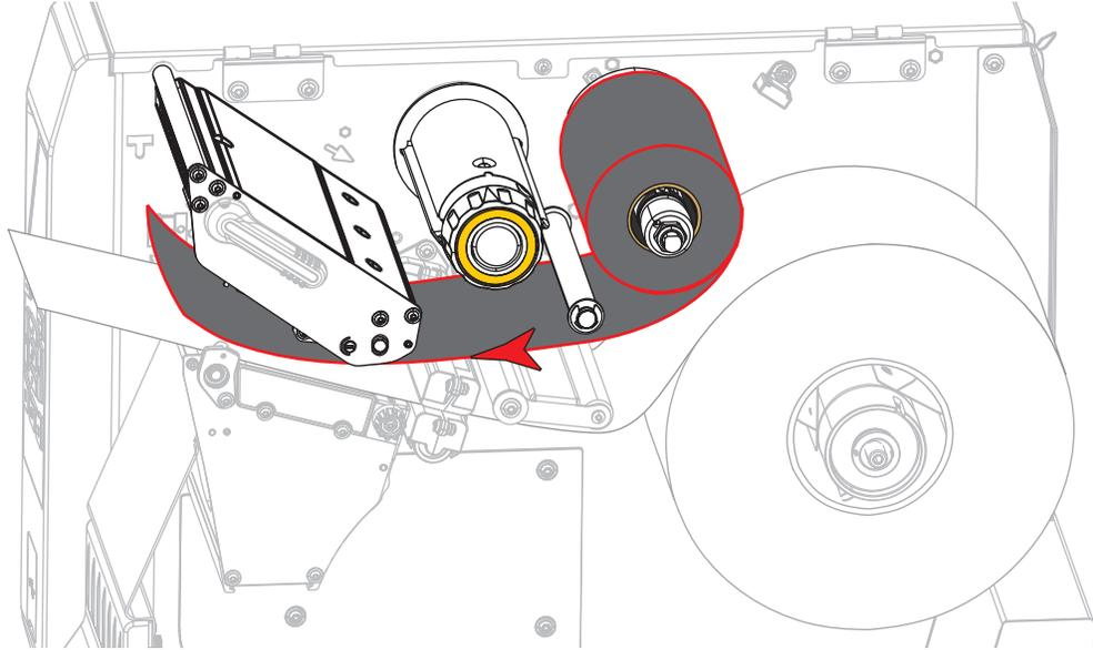
5. 通过打印头总成下方的色带应尽量向后靠，然后将色带卷绕在色带拾取轴上。按照所示方向将色带拾取轴旋转几圈，拉紧并对齐色带。
