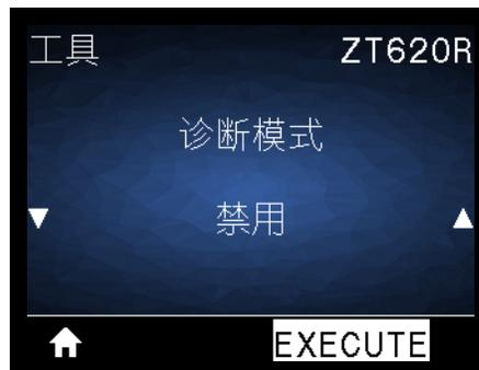
使用此诊断工具可以让打印机为打印机接收到的所有数据输出十六进制值。有关详细信息，请参见第 237 页的“通信诊断测试”。
