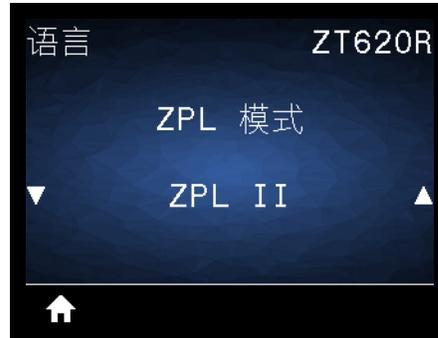
选择与标签格式中使用的值匹配的模式。本打印机可以接受使用 ZPL 或 ZPL II 语言编写的标签格式，不需要重新编写任何已经存在的 ZPL 格式。在使用下列一种方法更改模式之前，打印机一直在选定的模式下工作。
