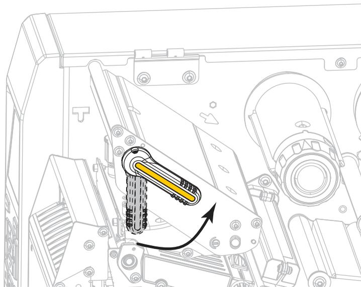
3. 如图所示，旋转介质导板调节旋钮，直到介质导板完全滑出。
