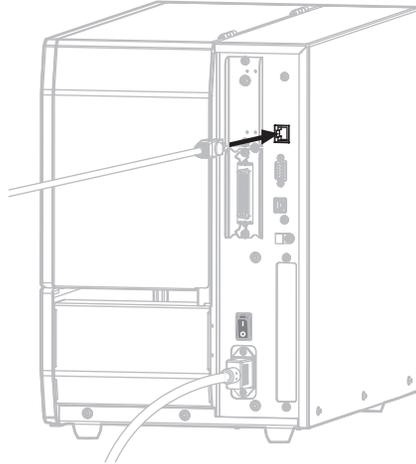
打印机尝试与网络进行通信。如果成功，将自动填写 LAN 网关和子网值，并获取 IP 地址。打印机显示屏将交替显示打印机的固件版本及其 IP 地址。
