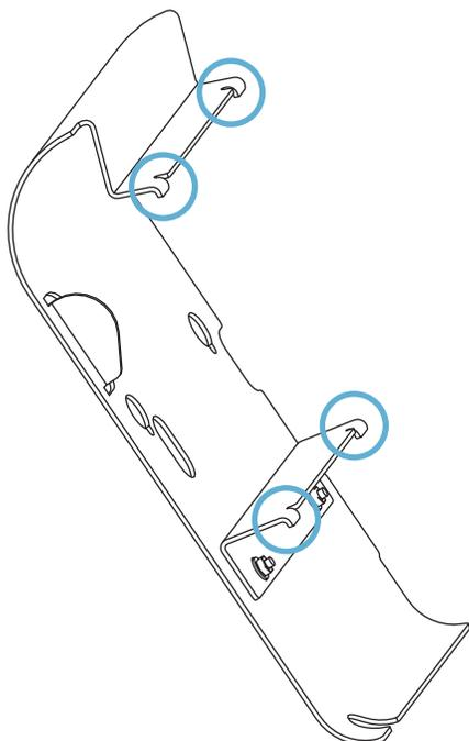
3. 将回卷辊上的安装卡扣插入打印机的安装槽，然后将回卷辊滑向左侧，直至无法移动为止。
