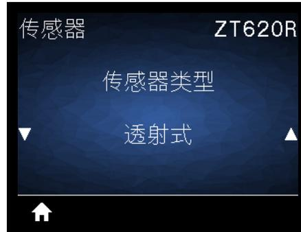
选择适用于用户所用介质的介质传感器。反射式传感器通常只用于黑色标记介质。透射式传感器通常用于其他介质类型。
