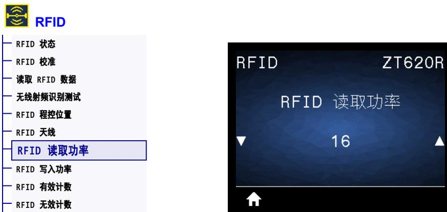
如果通过 RFID 标签校准没有达到所要求的读取功率，则可能要指定一个值。
