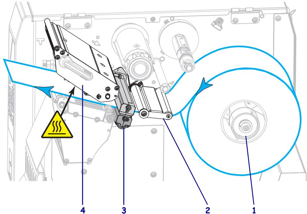
5. 如图所示，旋转介质导板调节旋钮，直到介质导板刚好接触到介质边缘。
