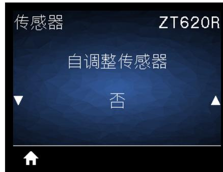
启用该设置，让打印机自动尝试检测介质设置。如果该设置不能正确检测介质，您还需要手动校准打印机。
