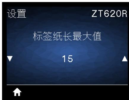
应将标签的最大长度设置为比标签的实际长度加上标签间隔缝至少长 25.4 毫米 (1.0 英寸)。如果该值设置得过小，打印机将认定已装入连续介质，并且无法校准。
