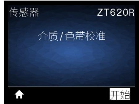
校准打印机，调节介质和色带传感器的灵敏度。
