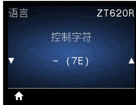
打印机需要使用这个两位十六进制字符来指示 ZPL/ZPL II 控制指令的起始点。设置控制前缀字符，使其与标签格式中使用的值匹配。
