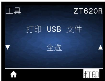
打印机会加载所有可执行文件并进行处理。可用文件被列出。“全选”可用于打印 USB 闪存盘中的所有文件。
