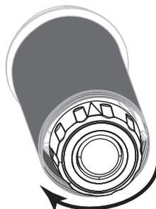
色带松开杆向下旋转，放松轴杆对旧色带的拉紧程度。
