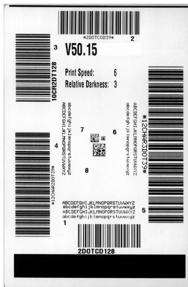
4. 参见第 227 页的“条形码质量判断”。检查测试标签并确定哪张标签具有适合您应用的最佳打印质量。如果有条形码检验器，可以使用它测量条形 / 空隙并计算打印对比度。如果没有条形码检验器，则可以使用目测方法或系统扫描仪根据在本自检中打印的标签选择最佳打印色深度设置。
