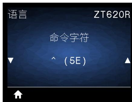
格式命令前缀是一个两位十六进制值，在 ZPL/ZPL II 格式指令中用作参数位置标记符。打印机寻找这个用于指示 ZPL/ZPL II 格式指令起始点的十六进制字符。
