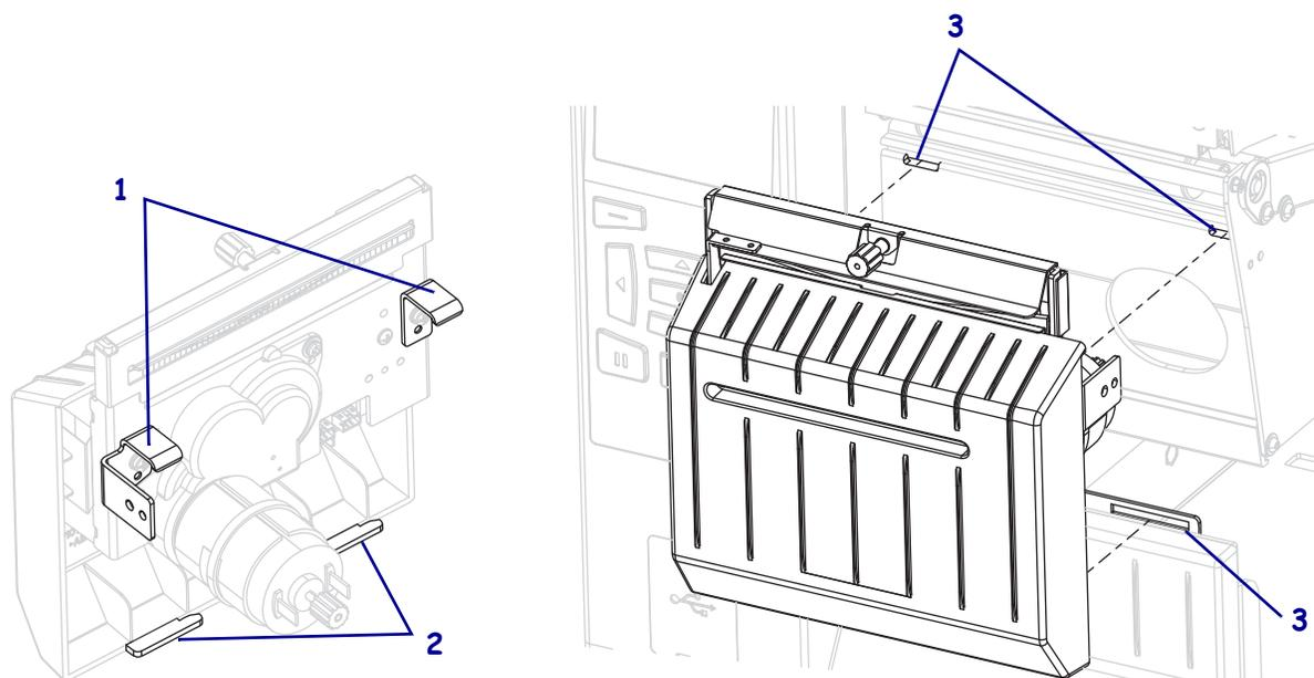
8-f. 向左滑动切纸器模块，然后重新安装好切纸器安装螺钉。
