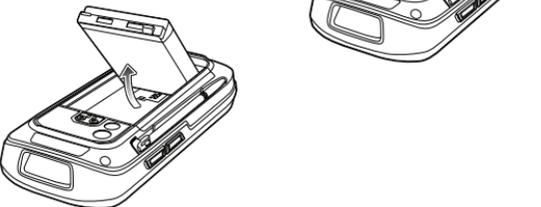
注意：要解锁并取下电池盖，请向左滑动电池盖锁，直至绿色指示灯与弹出图标处在同一直线上，且红点可见。电池盖轻轻弹出。提起并将其取下。
