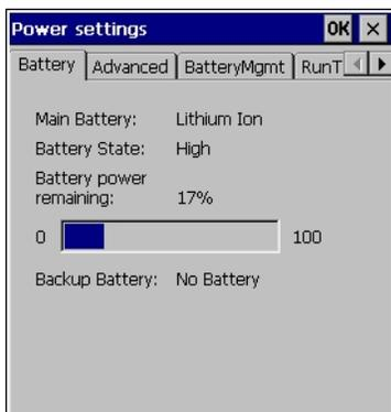
**Battery Power remaining** (剩余电池电量) 列出了使用满电量百分比表示的电池电量。
