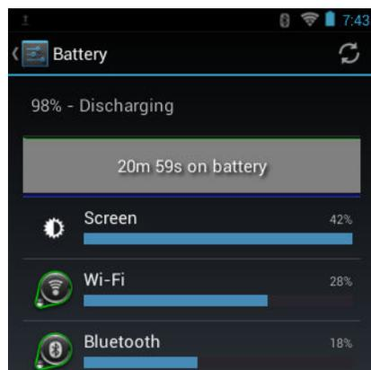
电池使用状况屏幕列出了正在耗电量的应用程序。屏幕顶部的放电图显示了自上次充电以来的电池放电速率（连接至充电器时图标底部会短时间出现绿色的细线），以及电池电量的总耗时。
