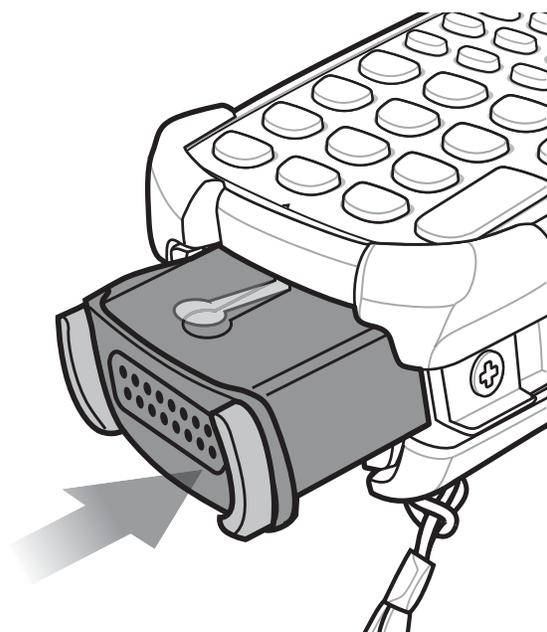
图 1-2 安装主电池
