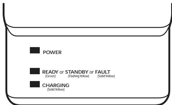
图 5-16 UBC 适配器 LED 指示器
