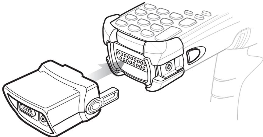
图 5-12 连接 CAM
