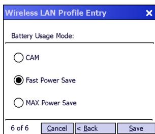
图 2-25 Battery Usage Mode（电池使用模式）对话框
