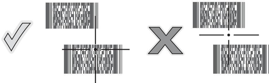
图 3-4 带有多个条码的标准距离拣选模式
