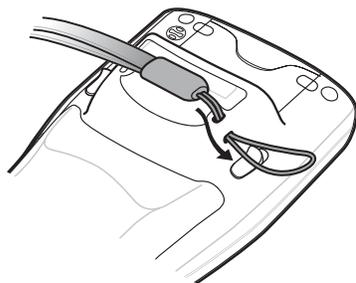
图 1-11 将绳环插入拴系点
