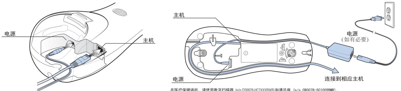
在医疗保健场所，请使用数字扫描器 (p/n DS6878-HC2XXXBWR) 和通讯座 (p/n CR0078-SC1009BWR)，并将磁芯置于电源上 (请参阅盒中随附的磁芯安装说明)。
